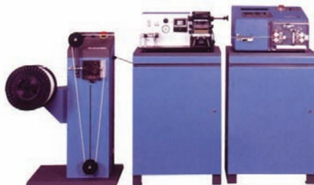
La marcadora de hilo por estampado en caliente modelo 67200, operando en línea con la AutoStrip modelo 4900 y el prealimentador modelo 6415.
