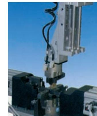
Alimentador preformador neumático para corte y formado de componentes radiales.
