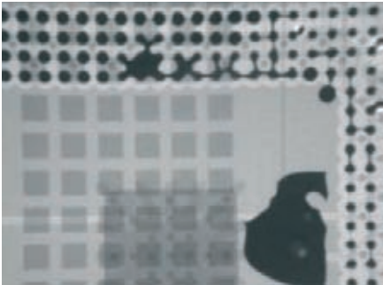
BGA con cortocircuito Reflujo pobre Contorno pobre
