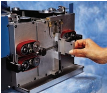
En los modelos 8000 y 7400 se usa un cassette compacto y robusto para cargar las cuchillas en el respectivo soporte.
